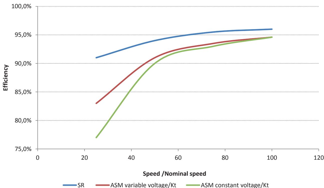
**ALTA DINAMICA:** l'assenza di perdite rotoriche fondamentali può essere utilizzata per **ridurre la dimensione del motore**, a parità di potenza resa, a seguito dell'importante riduzione del calore da dissipare, e questo comporta diversi vantaggi, che verranno descritti nella sezione sui motori per automazione quadri lamellari.
